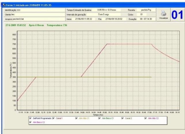
Figura 1: Curva de queima típica do método
