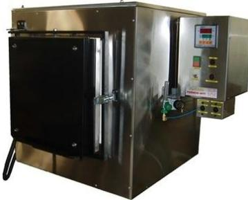
Forno automatizado com sistema de exaustão com catalisador para realização de síntese de nano partículas via método dos precursores poliméricos (Método de Pechini), para obtenção de filmes finos e demais procedimentos que exigem queima controlada de matéria orgânica.
