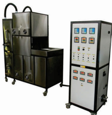
FE 1600/RC Obtenção de Silício Solar com Resfriamento Direcionado
