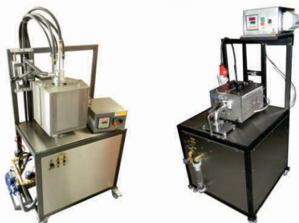
FPSD 1200 V ou H Forno de Solidificação Direcionada Vertical ou Horizontal
