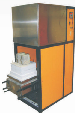
FCDCE 1200 Teste de Condutividade Térmica à Fio Quente
