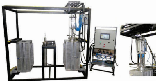
RDI-RUL 1200/3Z Forno para Realização de Ensaio de Redutibilidade do Minério de Ferro, Conforme Normas ISO e Métodos Padronizados
