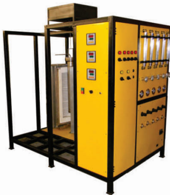
REDU-RDI-RUL-PLC-ISO Pellets Forno para ensaios de Redução de Pelotas de Ferro Índice de Degradação e Redução sob carga
