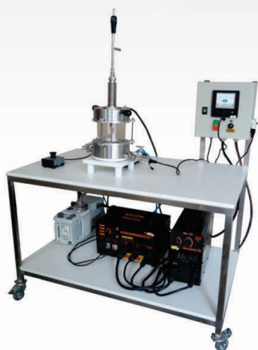
Arco Voltaico Fusão para Metais em Atmosfera Controlada Acima de 2000°C.
