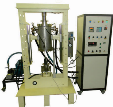
GEP 2000 Forno de alta Temperatura com Resistências de Grafite para 2000°C 400kg/cm2
