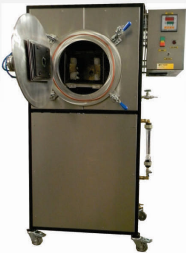
MVC 1100 À VÁCUO 10-3mbar 1100°C
