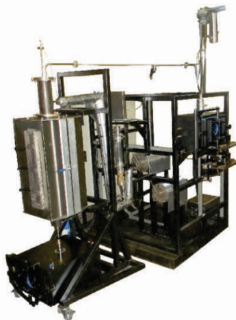
FORNO DE LEITO FLUIDIZADO CONTÍNUO de 76 ou 100 mm 1200°C
