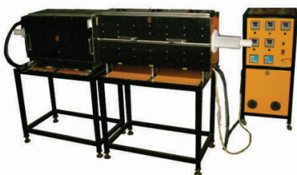
FBCAR Forno para produzir Fibra de Carbono 1600°C
