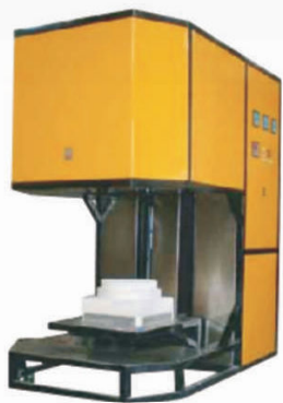
ME 1700/80 V/E Forno com Elevador para Fundição de Vidros 10 Litros de amostra
