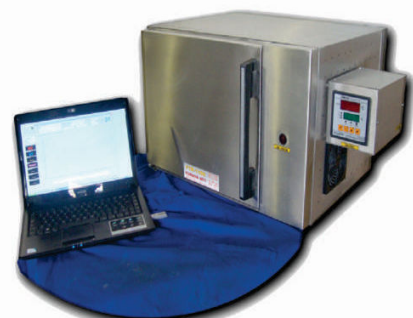
FMO 1200 e 1600 Forno Microondas para Ensaios de 1200°C e 1600°C
