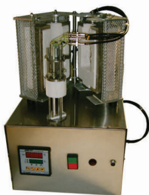
FTCE 1000 3 Forno para Teste de Condutividade Elétrica de 3 amostras a 1000°C
