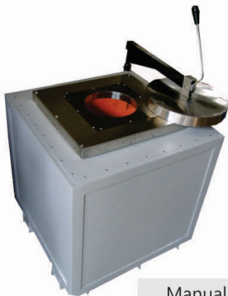
POF 1300 Forno Poço Fixo para Fundição de Metais de 7 a 30 Litros
